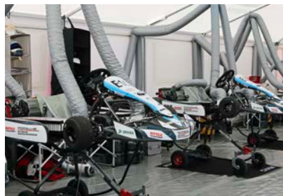
Um schneller laden zu können, pusten Gebläse Kühlluft auf die Akkus
