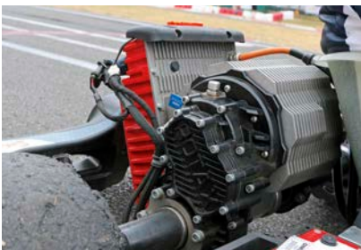
Ohne Kette treibt der Elektromotor über das Getriebe direkt die Starrachse an
